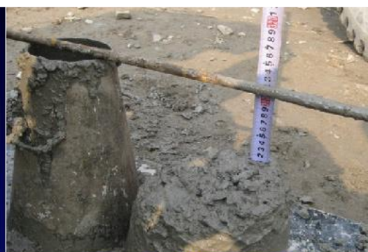
混凝土坍落度的检测
