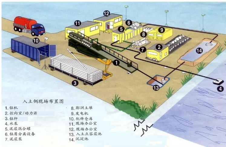
(7)钻机的选择应以回拉力估算值小于或等于 70%的钻机额定的回拉力为依据，结合施工工艺及现场条件等具体确定。导向钻头应根据地层等选定（见表 1K415032-3）。扩孔钻头应根据地层、铺管长度、铺管外径、施工工艺等选定（见表 1K415032-4）。导向仪应根据工程规模，铺设管线穿越障碍的类型，管线铺设深度及施工现场周边环境选择使用。
