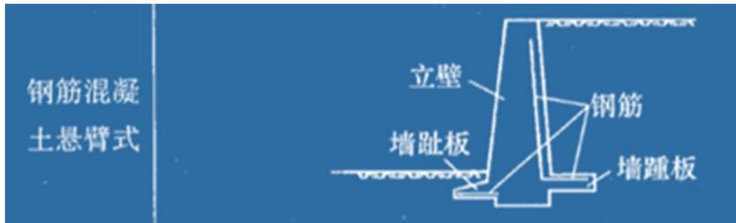
(1) 采用钢筋混凝土材料，由立壁、墙趾板、墙踵板三部分组成；
