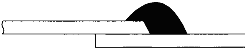
图1K416012-5 单缝挤压焊接焊缝示意图
