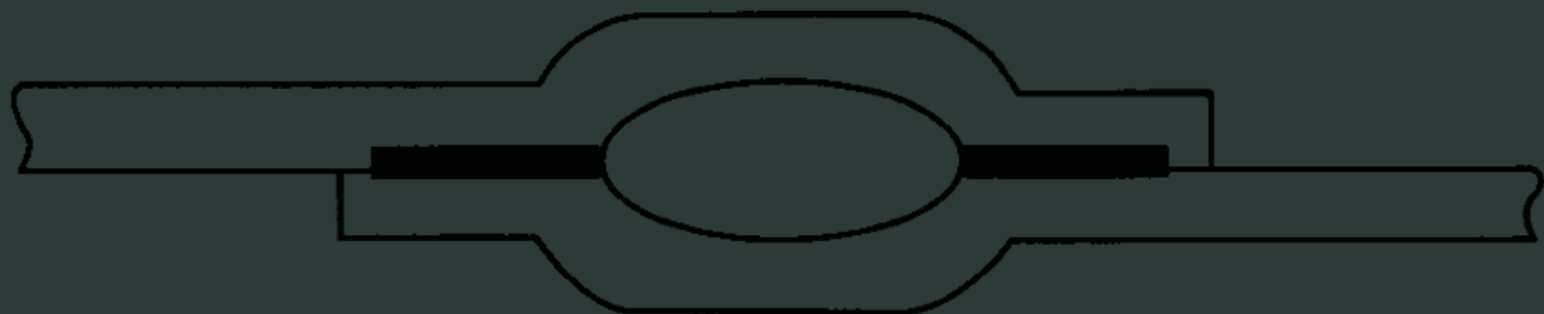
图1K416012-4 双缝热熔焊接焊缝示意图
