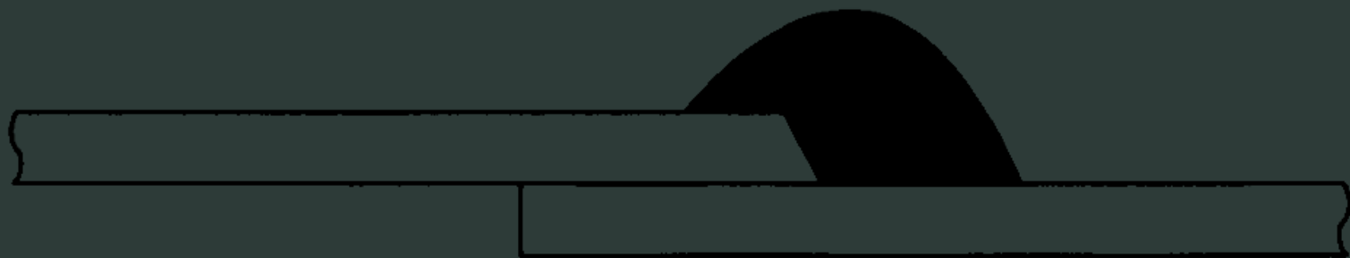
图1K416012-4 双缝热熔焊接焊缝示意图
