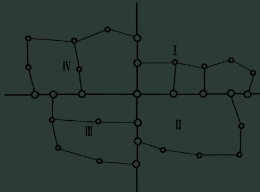
图1k417012-2 导线控制网
