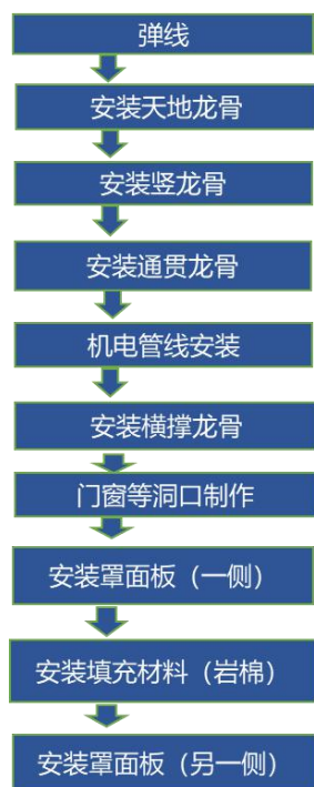
板材隔墙施工工艺流程
