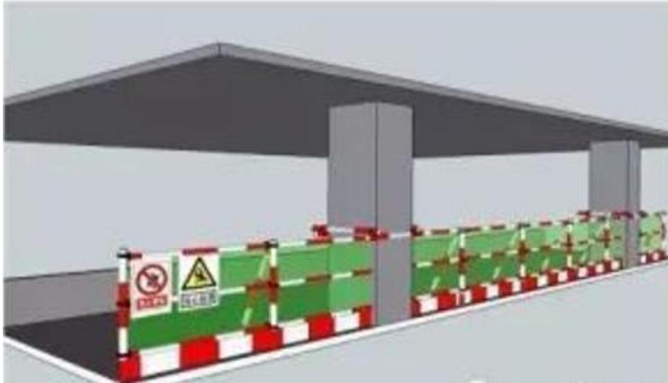
(2) 施工升降机、龙门架和井架物料提升机等在建筑物间设置的停层平台两侧边，应设置防护栏杆、挡脚板，并应采用密目式安全立网或工具式栏板封闭。
