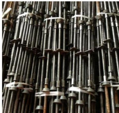
B.新型：止水螺栓可部分拔出再利用，螺栓孔用防水砂浆填塞。
