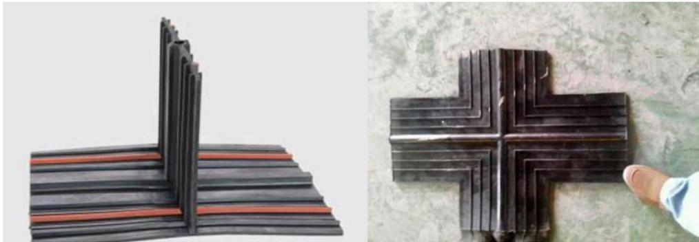
(4) 金属止水带接头应按其厚度分别采用折叠咬接或搭接;搭接长度不得小于 20mm;咬接或搭接必须采用双面焊接。
