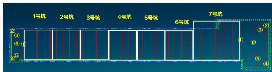
顺序1：两侧端头井对称开挖1号、7号坑—2号、6号坑—3号、5号坑—4号坑
