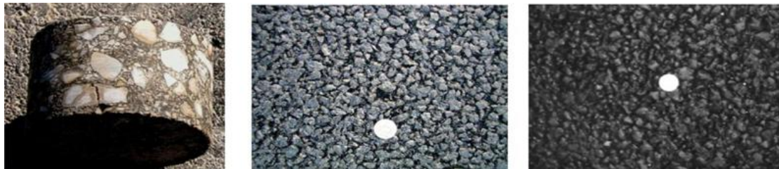
a) 密实—悬浮结构 b) 骨架—空隙结构 c) 骨架—密实结构
