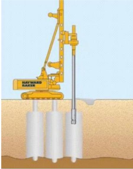
(1) 施工钻进过程中应保持连续喷射压缩空气，保证喷灰口不被堵塞，钻杆内不进水。
